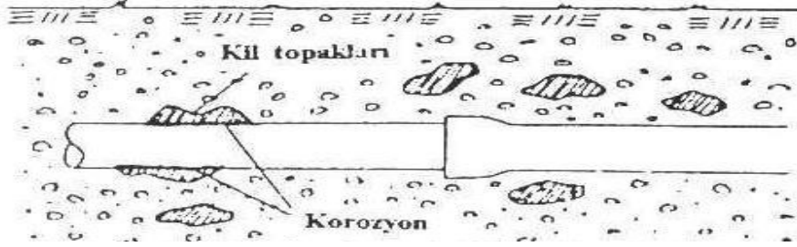
Şekil 2. Boru yüzeyine yapışan kilin neden olduğu korozyon
