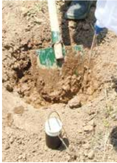
Şekil 2.2.1. Gerilim farkını ölçmek için bir kablo ile birleştirilen iki elektrottan birinin hazırlanan çamurlu çukura yerleştirilmeden önceki görüntüsü.
