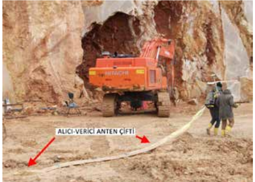
Şekil 2: Maden çalışmalarında arazi şartlarına göre anten çiftlerinin tasarımı değişebilmektedir. Resimde kablo tasarımı ve 25 Mhz merkez frekansında çalışan bir alıcı-verici anten ünitesi gömülü mermer haritalama çalışmasında görülmektedir.
