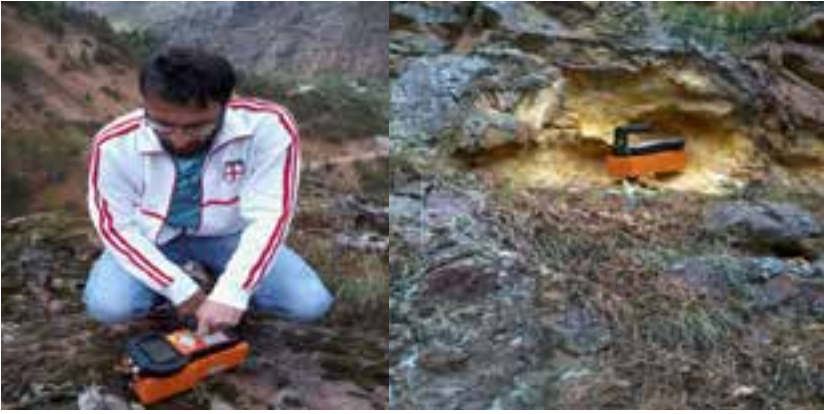
Şekil 3. Gamma ışını spektrometresi ile yerden ölçüm alınması.
