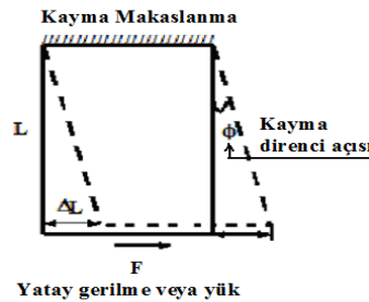
Şekil 11. Yatay yatak katsayısı deformasyon türü.
