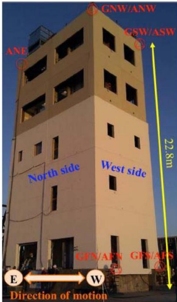
Şekil 4. Bina üzerinde ve çevresindeki GNSS/İvmeölçerler ile kalıcı yerdeğiştirme ve eğikliklerin ölçülmesi (Bock ve diğ., 2013).
