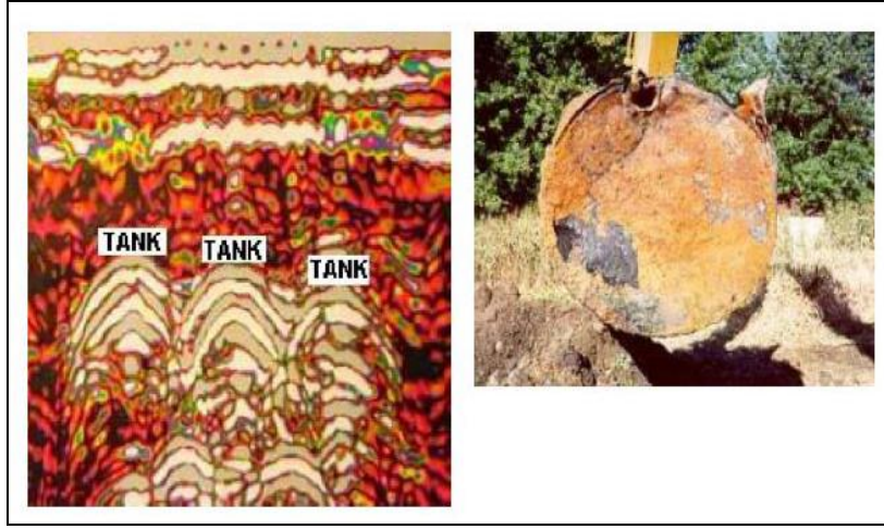
Şekil 29. Üç tane yer altı depolama tankının (YDT) 400 MHz anten ile GPR görüntüsü (solda) ve YDT'nin yeryüzüne çıkarılmış görüntüsü (sağda). [20].
