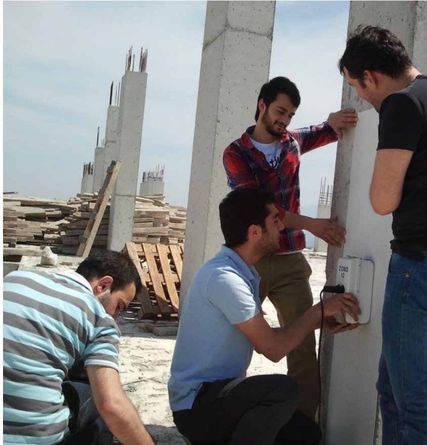
Şekil 1. Kolon üzerinde yer radarı ile ölçü alınması (Aydın vd., 2013).
