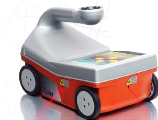
Şekil 4. Yapı Jeofiziği'nde kullanılan 1.6 GHz frekansında ölçü alabilen yer radarı sistemi (GSSI, www.geophysical.com)
