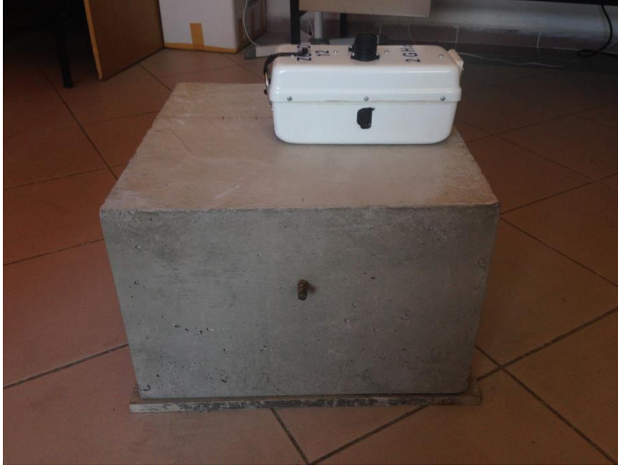
Şekil 1. Deney modeli (C-30 betonu) ve 2 GHz lik yer radarı anteninin fotoğrafı (Kaplanvural vd., 2015)
