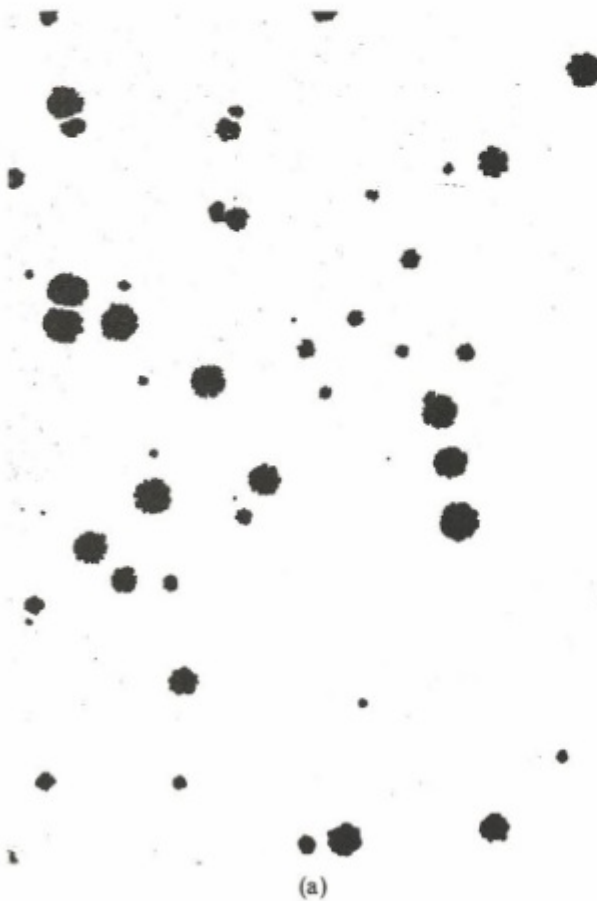
Şekil 5. (a) Pasif Radon Detektörü üstünde alfa izleri ve (b) Ev içi radon konsantrasyonu dağılımı histogramı.
